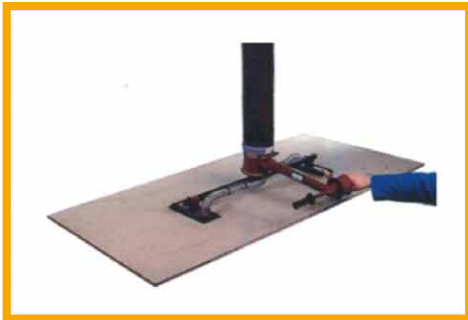
Poignée de commande rallongée. Palonnier équipé de 2 ventouses réglables. Pour manutention de panneaux, tôles, etc. Charge 80 kg
