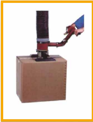
Poignée de commande rallongée, articulée. Ventouse carton double coupleur. Charge 50 kg
