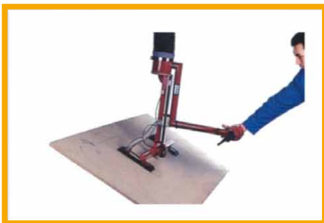
Retourneur de panneaux. Poignée de commande rallongée. Palonnier équipé de 2 ventouses réglables. En cours de basculement. Charge 50 kg
